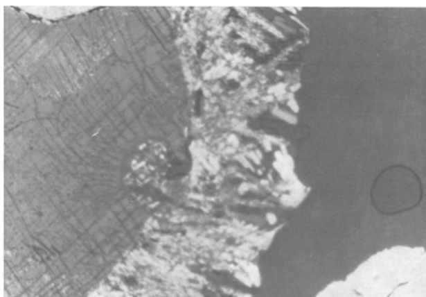
Cliché 2. Au cours du chauffage fusion de l'eutectique et apparition d'un couloir entre les deux constituants cristallisés observés dans le même champ du microscope que précédemment
