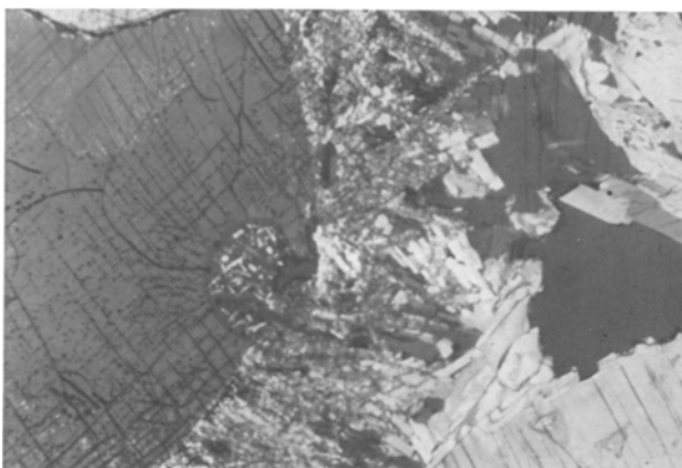
Cliché 1. Par la méthode de contact recristallisation de quatre phases, caféine(I), péritectique, eutectique et khelline(I)
